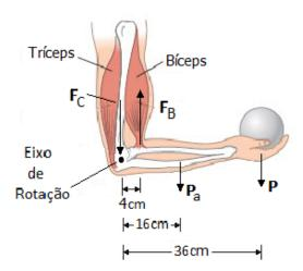
Sendo o módulo do peso P = 50 N e o módulo do peso do antebraço  $P_a = 20$  N, qual é o módulo da força  $\mathbf{F}_B$ ?
