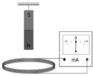
A deflexão do ponteiro do galvanômetro para direita/esquerda indica que a corrente elétrica fluindo na espira, vista desde o ponto de suspensão do ímã, tem sentido horário/anti-horário.
